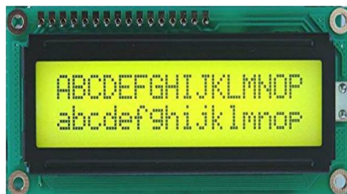
Fig.9 16X2 LCD display
