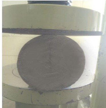
Fig.7 Split Tensile Test
